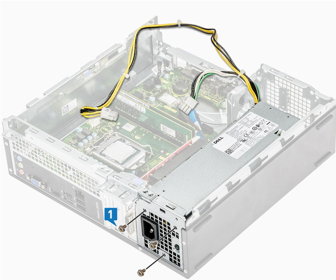
3. 将 PSU 电缆穿过的固定器。
